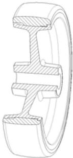
**Rivestimento:** in poliuretano iniettato, durezza 80 Shore A, ottime caratteristiche di scorrevolezza ed elasticità, buona resistenza ad usura e lacerazione.
