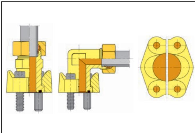
I collegamenti a flangia SAE possono essere forniti in esecuzione standard e ad alta pressione con schema di foratura a norma SAE J 518 oppure ISO 6162.
