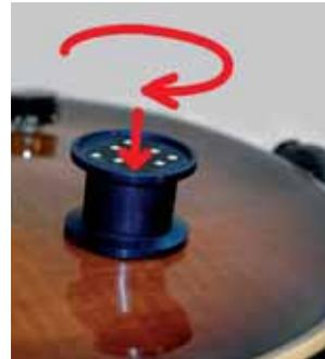
**3** Eine Rechtsdrehung um ca. 30° löst den Bajonettverschluss und die eingebaute Feder zieht den Adapter auf das Werkstück herunter - der Adapter ist einsatzbereit.
