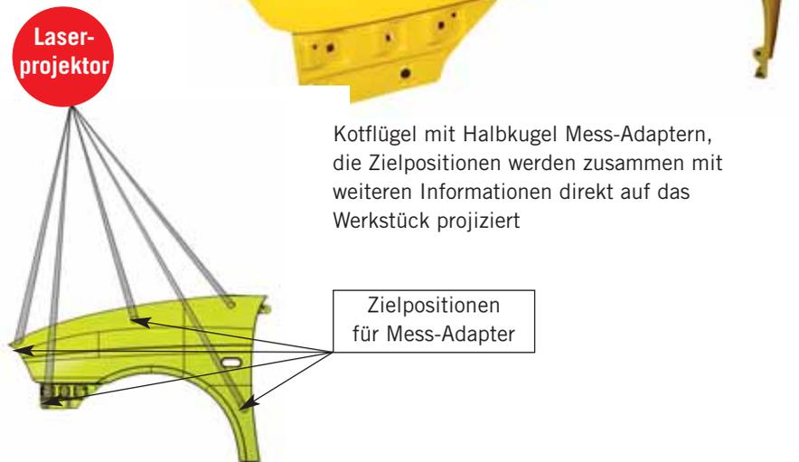
Kotflügel mit Halbkugel Mess-Adapttern, die Zielpositionen werden zusammen mit weiteren Informationen direkt auf das Werkstück projiziert
